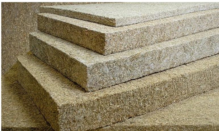
Une brique de Gramitherm, ce sont 72% d'herbe, 20% de fibres de jute recyclé et 8% de fibres synthétiques. GRAMITHERM
