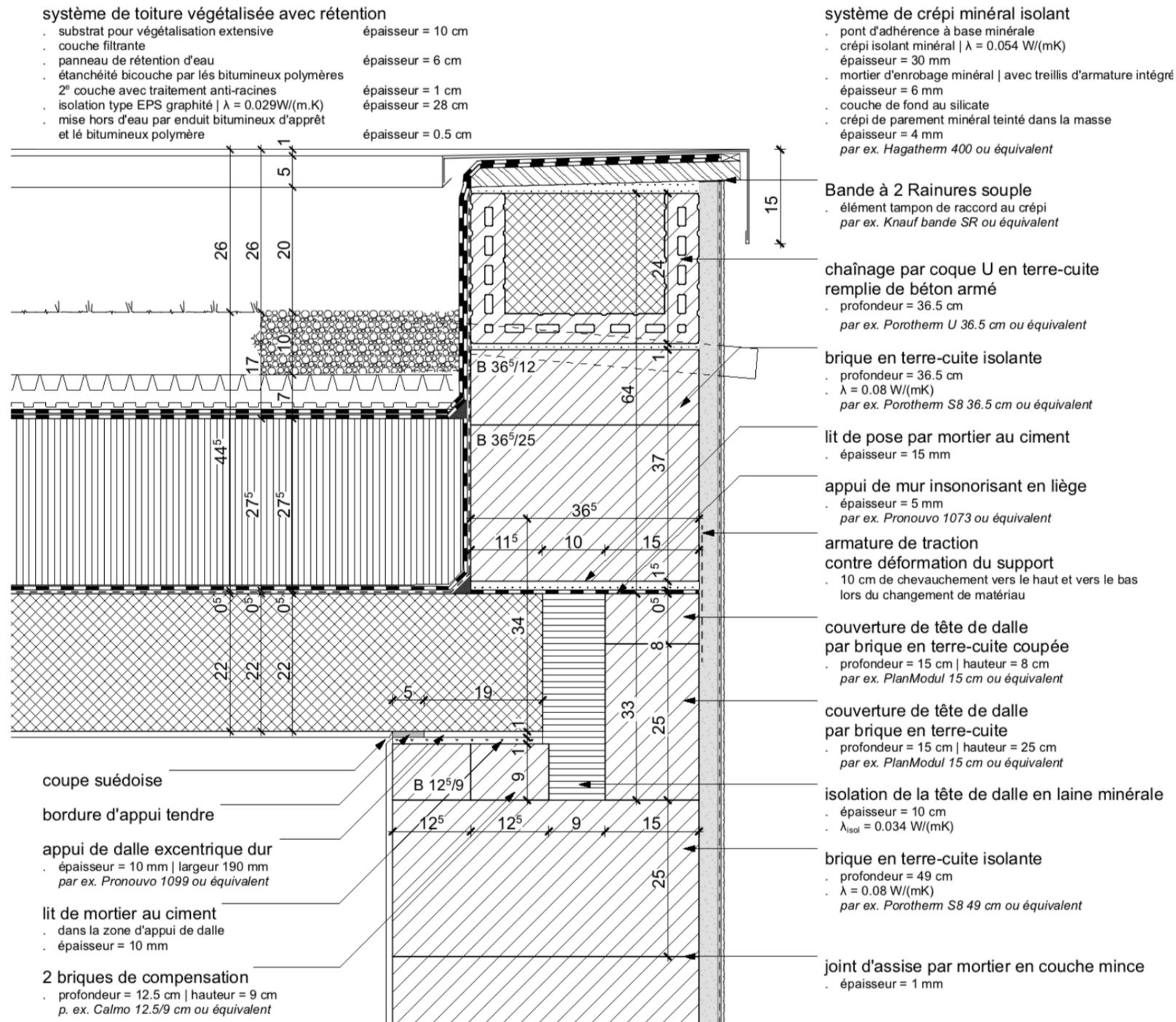
Détail appui de dalle, toiture 22 à 34cm 1:10
