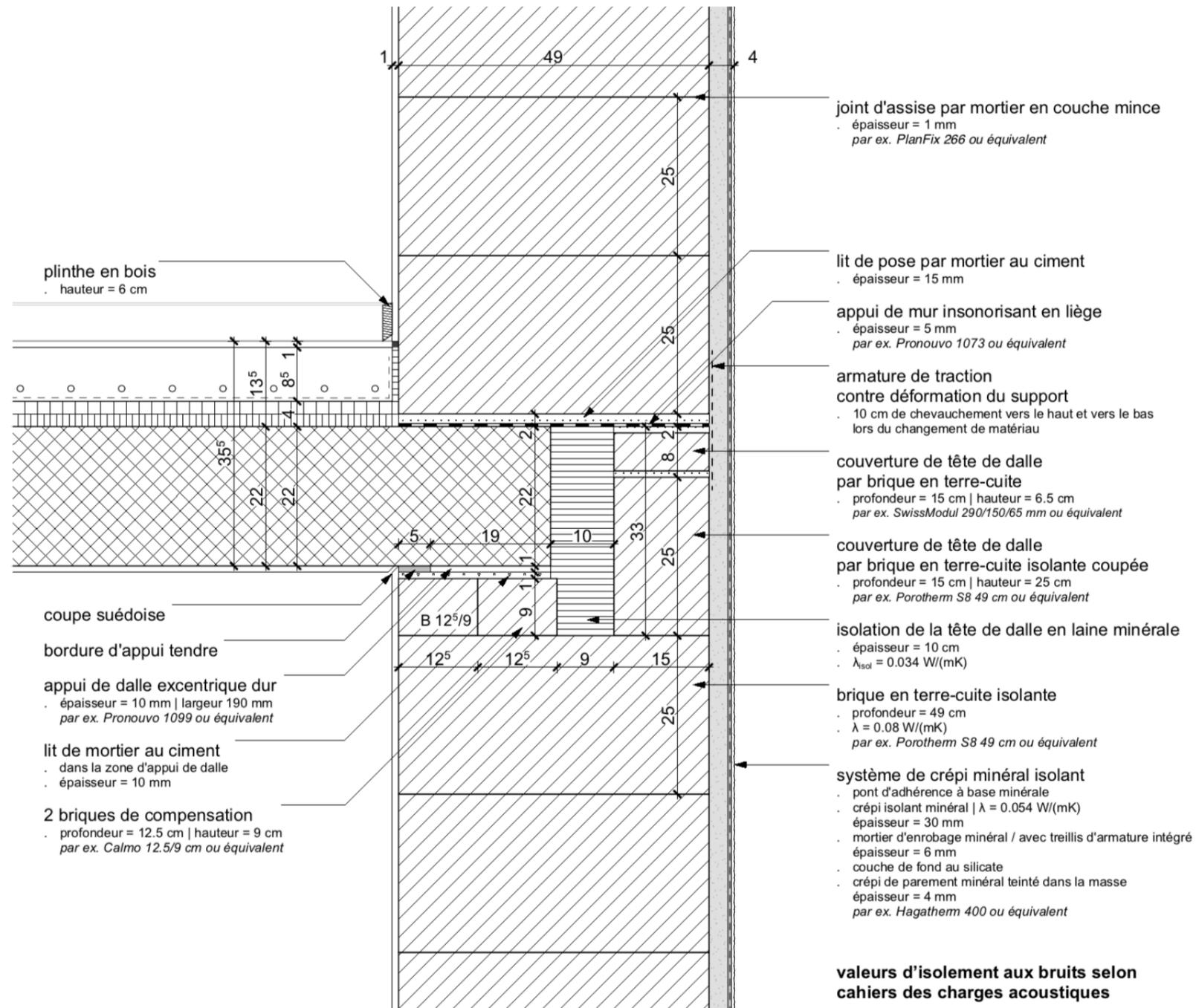
Détail appui de dalle, dalle type 22cm 1:10
