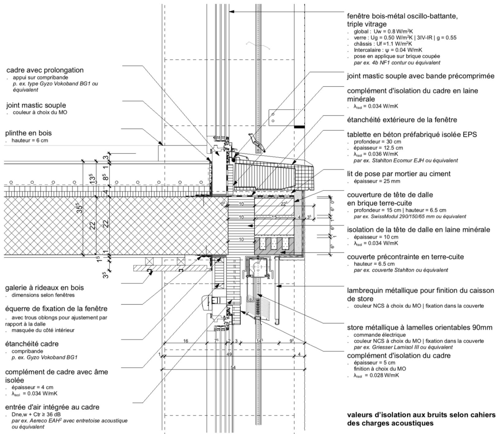
Détail appui de dalle, dalle type 22cm avec fenêtre 1:10
